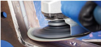
Amolado especialmente blando y flexible en el amolado frontal con discos de lija de  $\varnothing$  125 mm.
