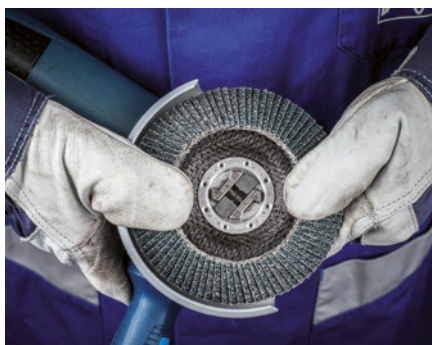
Narzędzie mocuje się poprzez lekkie dociśnięcie, aż do momentu charakterystycznego kliknięcia.
